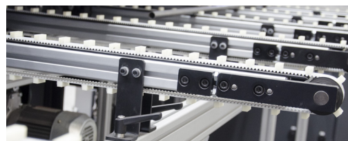
Modularer Taschenförderer aus Alu, in leichter Bauart angefertigt.
