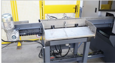
Getrennte Abfuhr der Zuschnitte und Reststücke. Mögliche Sortierung in mehrere Positionen für verschiedene Werkstücklängen. Für verschiedene Werkstücklängen geeignet.
