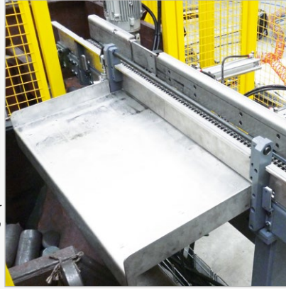
Getrennte Abfuhr der Zuschnitte und Reststücke. Mögliche Sortierung in mehrere Positionen für verschiedene Werkstücklängen. Für verschiedene Werkstücklängen geeignet.
